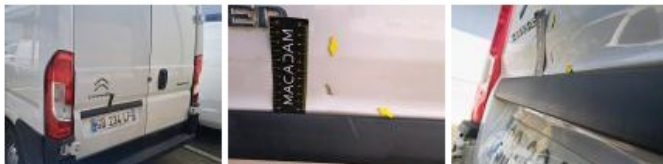
Pare-chocs AR, Déformé / Forcé, E - Remplacer
