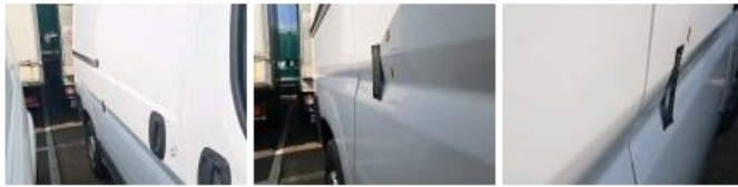
Moulure d'aile ARD, Dégrafé, Dépose/Répose
