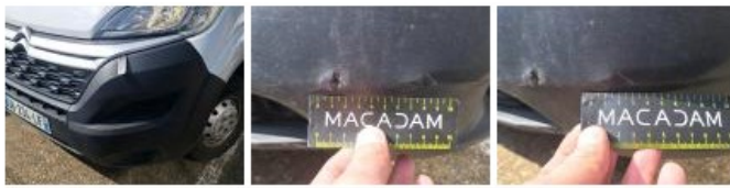
Aile AVD, Mauvaise réparation, LI - Réparer et peindre (complet)
