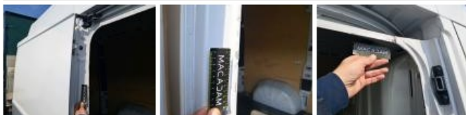
Joint de porte AR, Manque, E - Remplacer
