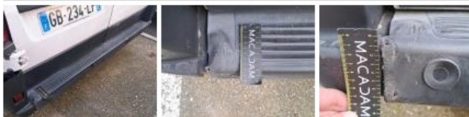
Capteur de parking AR, Cassé, E - Remplacer
