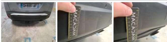
Pare-chocs AR, Déformé / Forcé, E - Remplacer
