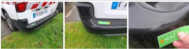
Pare-chocs AR, Déformé / Forcé, E - Remplacer
