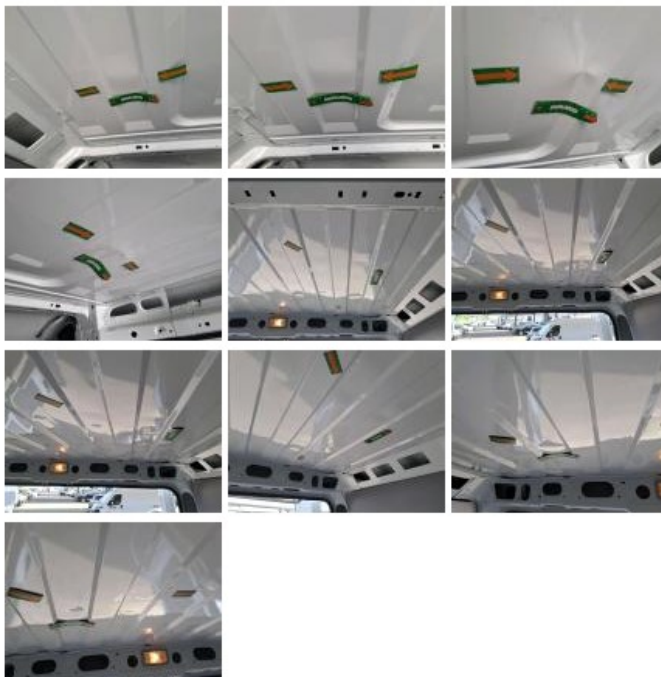
Pavillon caisse, Bosse(s), LI - Réparer et peindre (complet)
