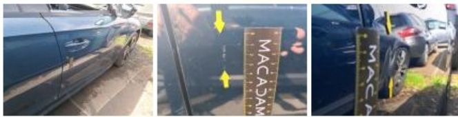
Porte ARD, Dégâts chimiques, LI - Réparer et peindre (complet)
