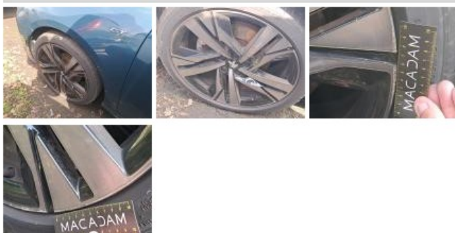
Pneu ARG, Déchirure, E - Remplacer
