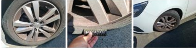
Jante alum. ARD, Griffe(s), E - Remplacer
