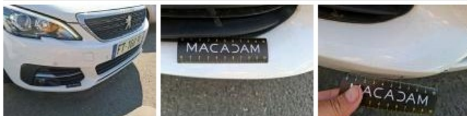
Grille de pare-chocs AV M, Dégrafé, Dépose/Répose
