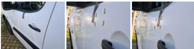
Panneau ARG, Bosse(s), LI - Réparer et peindre (complet)
