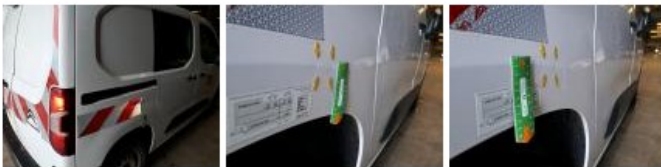
Bas de caisse ext D, Bosse(s) et griffe(s), LI - Réparer et peindre (complet)
