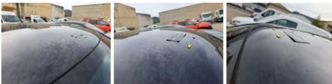
Pavillon, Bosse(s), LI - Réparer et peindre (complet)
