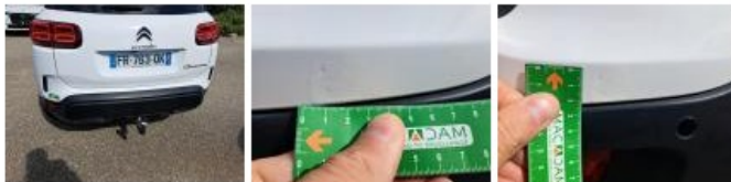
Pare-chocs AR, Mauvaise réparation, Peindre
