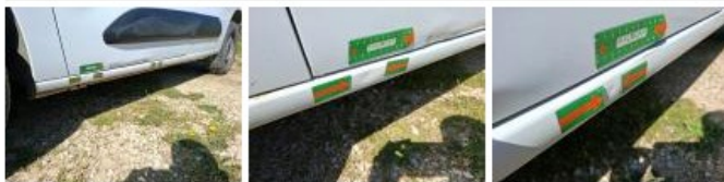
Moulure porte AVG, Griffe(s), Réparer/rempl. (montant forfaitaire)
