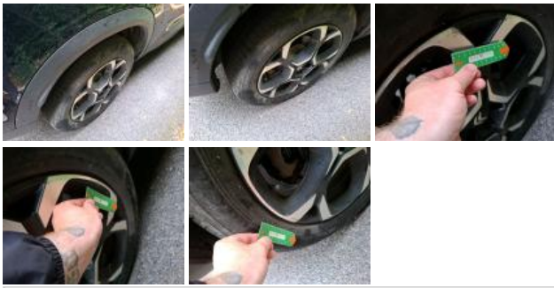
Pneu ARD, Hors tolérance, E - Remplacer
