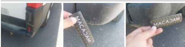
Porte de malle AR G, Bosse(s), LI - Réparer et peindre (complet)
