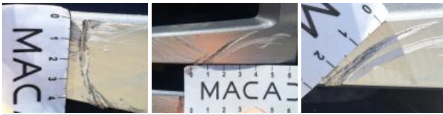
Pneu AVD, Hors tolérance, E - Remplacer
