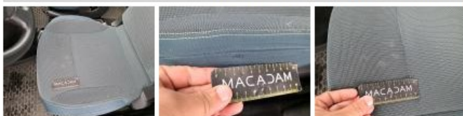
Revêtement dossier AVG, Déchirure, E - Remplacer
