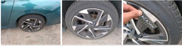
Pneu ARG, Déchirure, E - Remplacer
