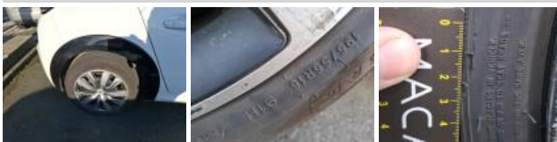
Enjoliveur de roue ARD, Déformé / Forcé, E - Remplacer
