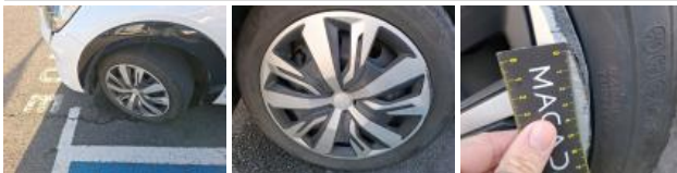
Pneu ARG, Déchirure, E - Remplacer
