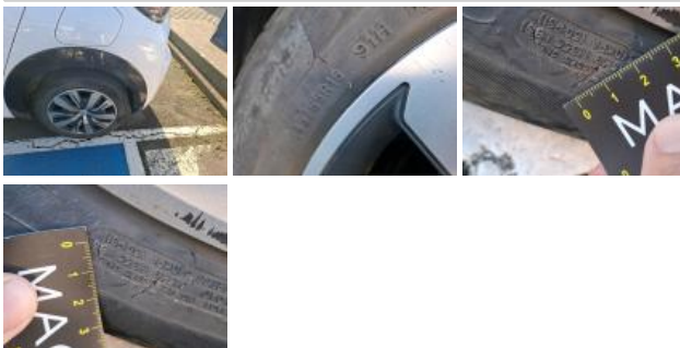
Pneu ARD, Déchirure, E - Remplacer
