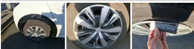
Pneu AVD, Hors tolérance, E - Remplacer
