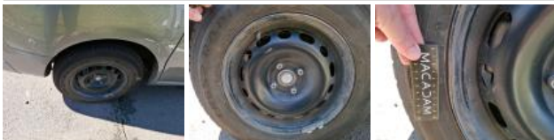
Enjoliveur de roue ARG, Manque, E - Remplacer
