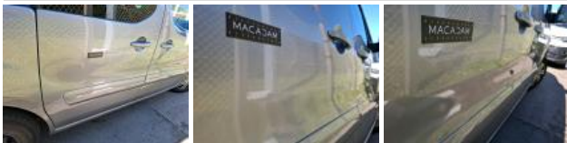
Porte AVD, Mauvaise réparation, Peindre
