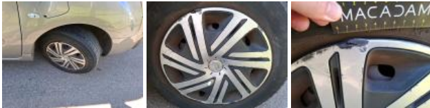
Enjoliveur de roue AVD, Déformé / Forcé, E - Remplacer
