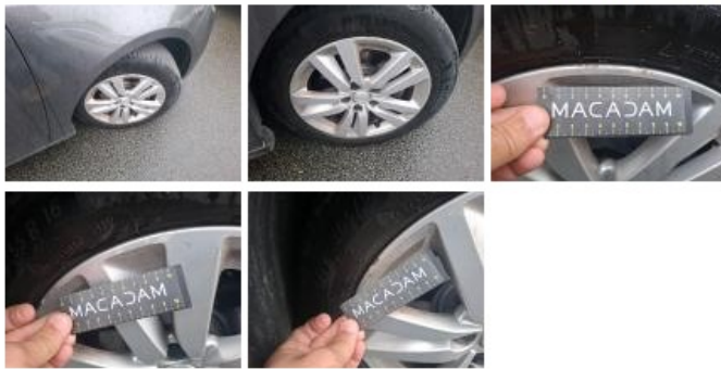
Pneu AVD, Déchirure, E - Remplacer
