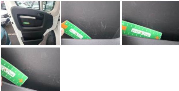
Couvercle boîte à gants, Cassé, E - Remplacer
