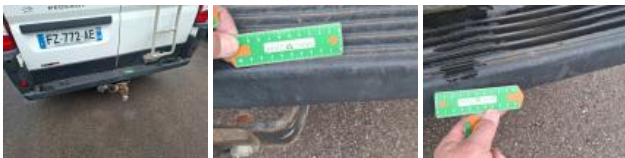
Porte de malle AR G, Rouille, Peindre
