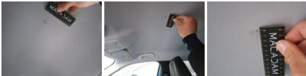
Garnit. montant Mil G, Griffe(s), Réparer/rempl. (montant forfaitaire)
