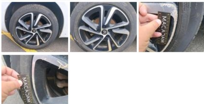
Pneu ARD, Hors tolérance, E - Remplacer
