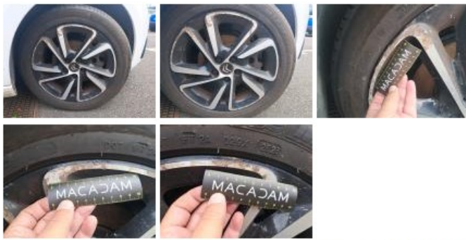
Pneu AVG, Hors tolérance, E - Remplacer
