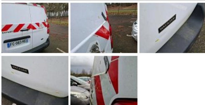
Feu ARD, Cassé, E - Remplacer
