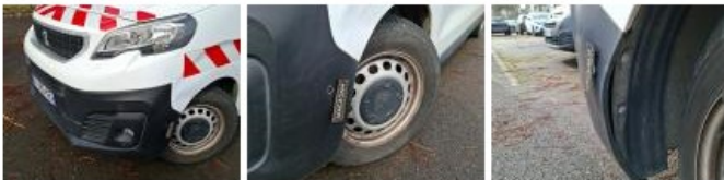
Pare-chocs AV, Déformé / Forcé, E - Remplacer
