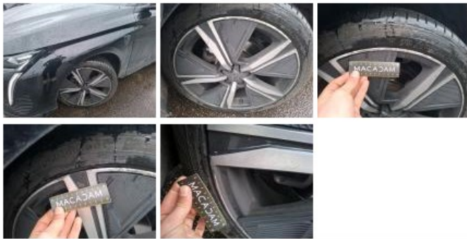
Pneu AVG, Déchirure, E - Remplacer
