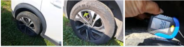
Pneu ARG, Hors tolérance, E - Remplacer
