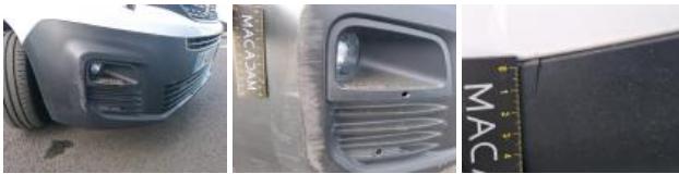
Panneau Latéral D, Bosse(s) et griffe(s), LI - Réparer et peindre (complet)
