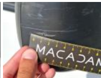
Boitier rétroviseur ext D, Griffe(s), E - Remplacer
