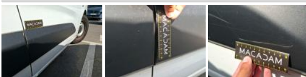
Moulure porte AVD, Griffe(s), E - Remplacer
