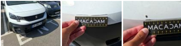
Pare-chocs AV, Cassé, E - Remplacer
