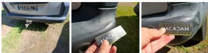
Pare-chocs AR, Déformé / Forcé, E - Remplacer
