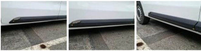
Moulure porte AVD, Griffes(s), E - Remplacer
