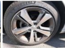
Jante alum. AVG bi-ton/polychrome, Griffe(s), Réparer/remplacer (montant forfaitaire)
