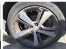
Jante alum. ARG bi-ton/polychrome, Griffe(s), Réparer/remplacer (montant forfaitaire)
