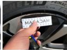
Jante alum. AVG bi-ton/polychrome, Griffe(s), Réparer/remplacer (montant forfaitaire)
