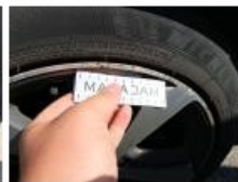
Jante alum. ARG bi-ton/polychrome, Griffe(s), Réparer/remplacer (montant forfaitaire)
