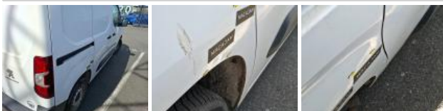
Moulure porte ARD, Griffe(s), E - Remplacer
