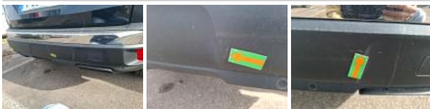
Pare-chocs AR, Griffe(s), Réparer/rempl. (montant forfaitaire)
