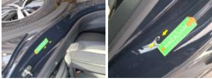
Bas de caisse int ARD, Bosse(s) et griffe(s), LI - Réparer et peindre (complet)
