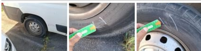
Répétiteur G, Fêlure, E - Remplacer
