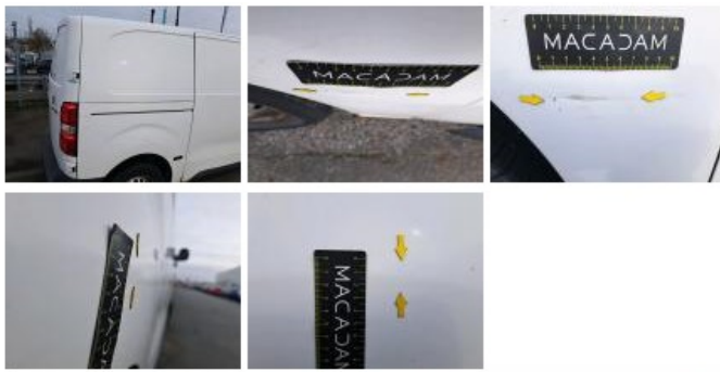
Porte coulissante D, Rouille, LI - Réparer et peindre (complet)
