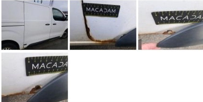
Bas de caisse ext D, Rouille, Le - Remplacer et peindre
