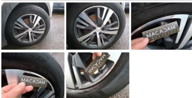
Pneu AVD, Hors tolérance, E - Remplacer
