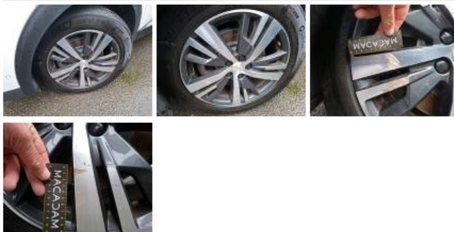
Pneu ARD, Hors tolérance, E - Remplacer
