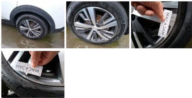
Pneu AVG, Hors tolérance, E - Remplacer
