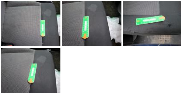
Revêtement assise siège AVG, Déchirure, E - Remplacer
