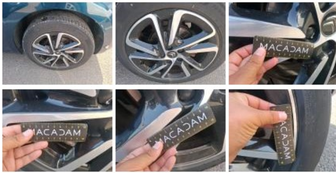
Pneu ARD, Hors tolérance, E - Remplacer
