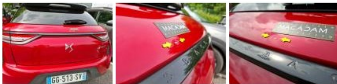
Feu central de hayon, Infiltration d'eau, E - Remplacer
