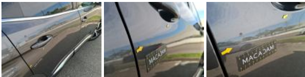
Porte AVD, Mauvaise réparation, Peindre
