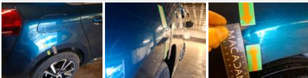
Bas de caisse ext D, Bosse(s) et griffe(s), LI - Réparer et peindre (complet)
