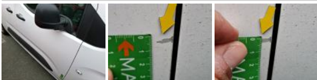
Porte de malle AR G, Bosse(s), LI - Réparer et peindre (complet)
