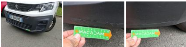
Coin de panneau ARD, Bosse(s) et griffe(s), LI - Réparer et peindre (complet)
