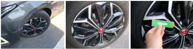
Jante alum. ARG bi-ton/polychrome, Mauvaise réparation, Réparer/rempl. (montant forfaitaire)
