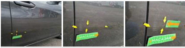
Moulure porte AVD, Cassé, E - Remplacer
