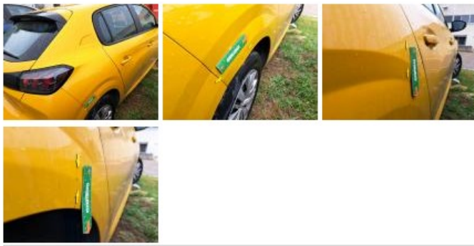
Moulure de pare-chocs AR, Griffe(s), E - Remplacer
