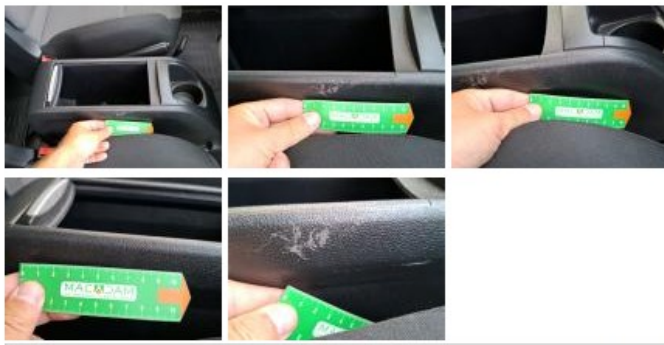
Console centrale, Cassé, E - Remplacer
