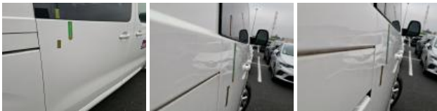
Moulure porte ARD, Cassé, Le - Remplacer et peindre
