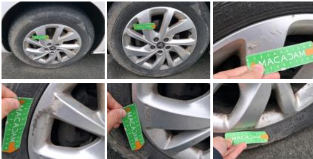
Pneu ARD, Déchirure, E - Remplacer
