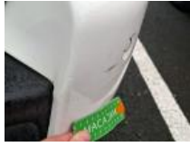
Coin pare-chocs ARD, Déformé / Forcé, LI - Réparer et peindre (complet)
