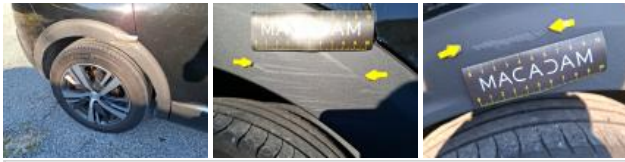
Moulure porte AVD, Griffe(s), Réparer/rempl. (montant forfaitaire)
