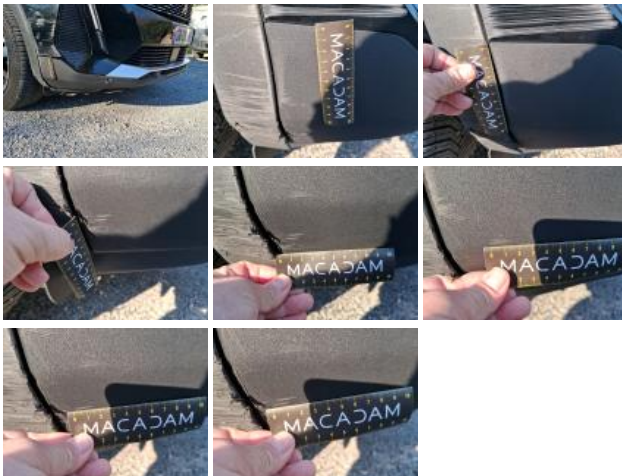
Moulure d'aile AVD, Griffe(s), E - Remplacer
