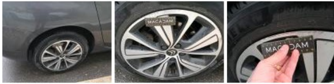
Jante alum. AVD bi-ton/polychrome, Griffes(s), Réparer/rempl. (montant forfaitaire)
