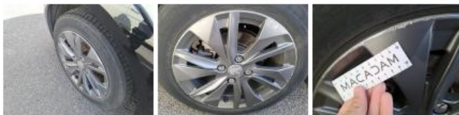
Pneu ARD, Déchirure, E - Remplacer
