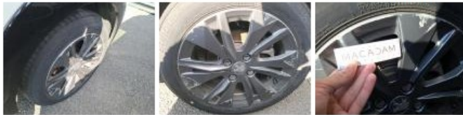
Pneu ARG, Déchirure, E - Remplacer
