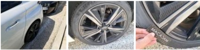
Pneu ARG, Déchirure, E - Remplacer
